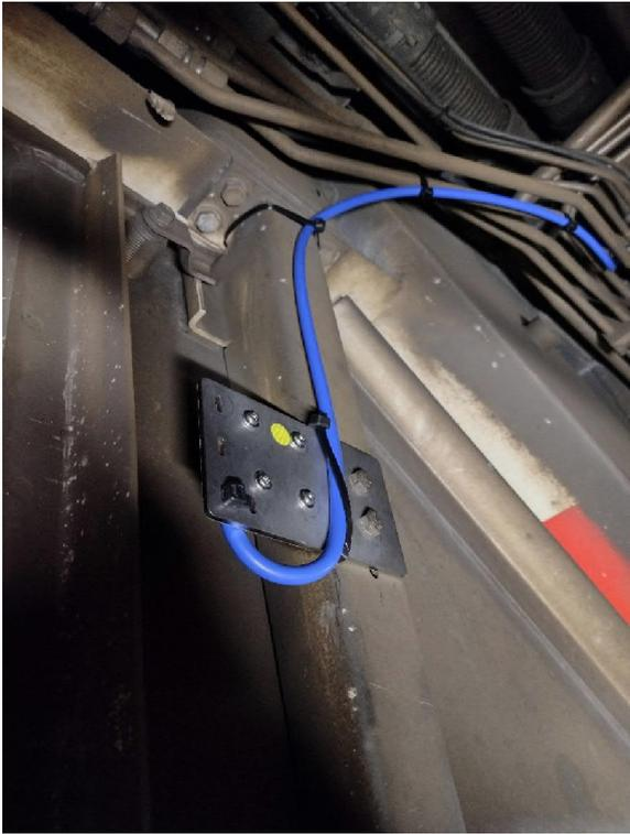
Figure 67: Capteur railnodeX avec microphone monté sur la caisse du véhicule de la Navette BDeh 2052
