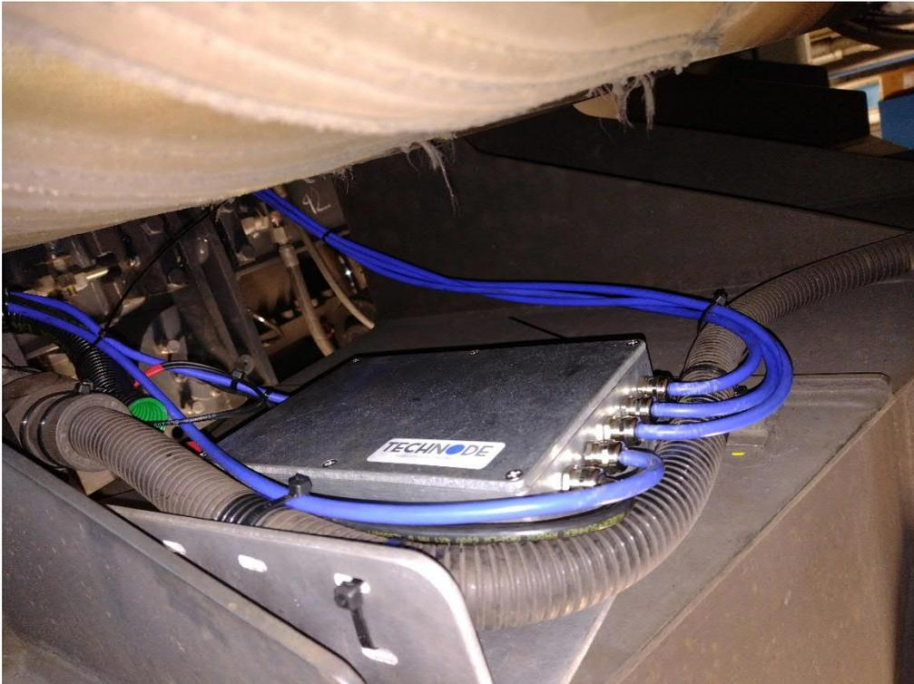
Figure 65: Unité centrale railnodeG montée sur la caisse du véhicule sous le soufflet au passage d'inter-circulation
