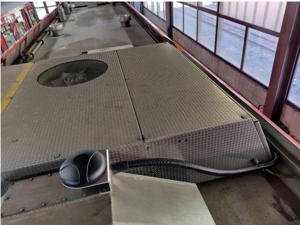
Figure 66: Antenne combinée LTE et GNSS sur le toit de la Navette BDeh 2052
