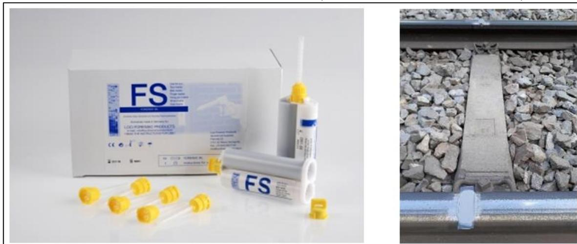
Abbildung 93: Forensic Sil, Foto: Loci Forensics B.V.1 (links), Abdruckmasse auf einer Schiene (rechts)
