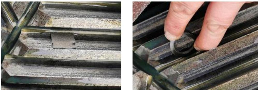
Abbildung 94: Probenahme eines Ölfilms mit einem Filz (links) oder eines Abtupfers und eines Rahmens zur Herstellung einer definierten Fläche (rechts)
