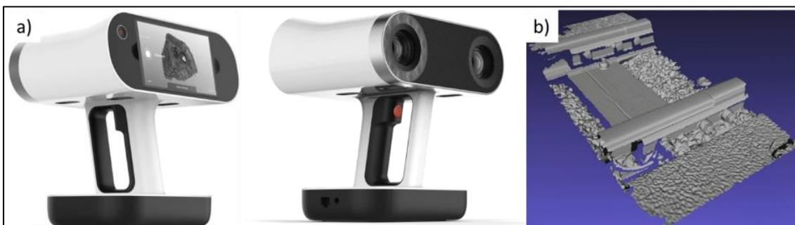
Abbildung 92: 3D-Handscanner: a) Artec LEO 3D-Scanner b) gescannter Gleisbereich
