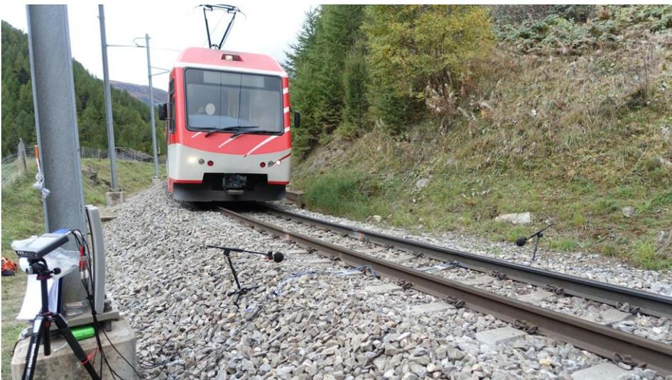
Abbildung 65: Instrumentierung der Kurve und Vorbeifahrt eines Triebzugs
