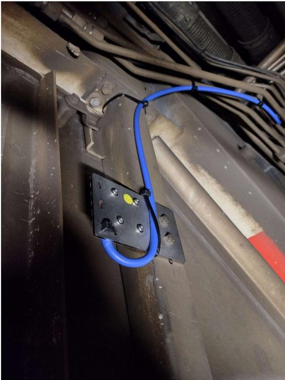
Abbildung 67: Sensor railnodeX mit Mikrofon montiert am Wagenkasten des Shuttles BDeh 2052
