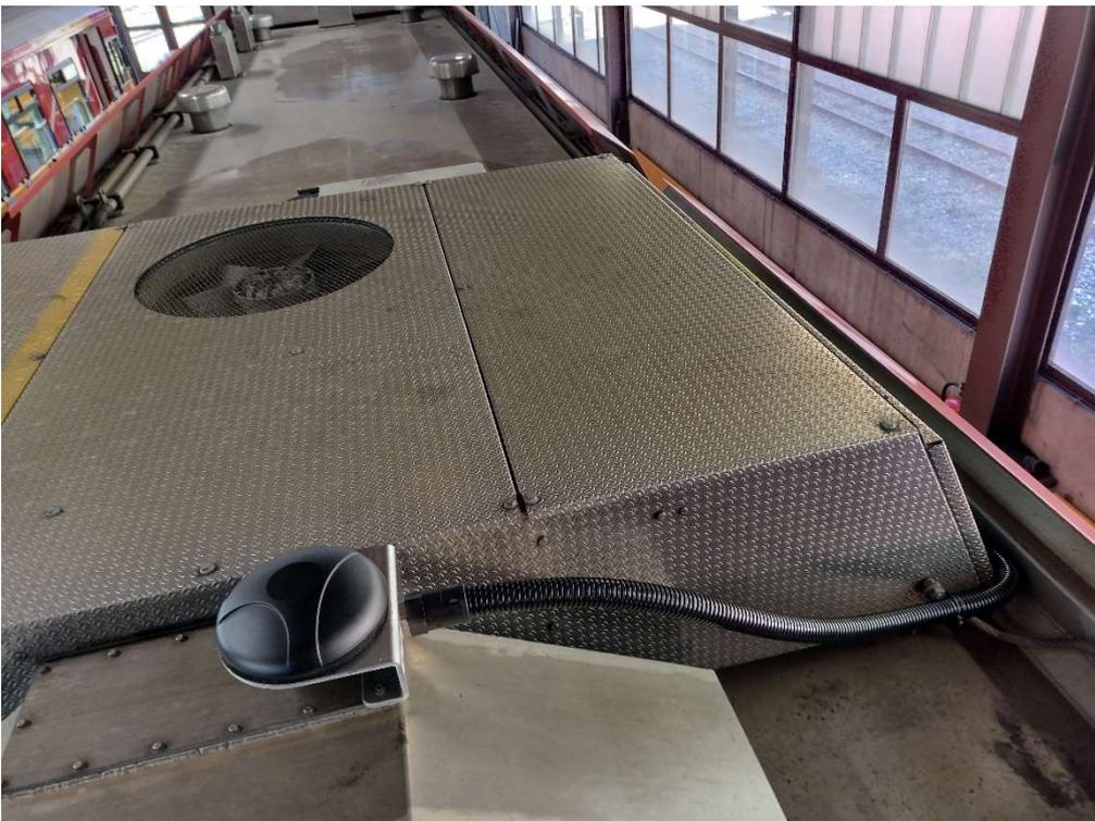
Abbildung 66: Kombinierte LTE und GNSS Antenne auf dem Dach des Shuttles BDeh 2052
