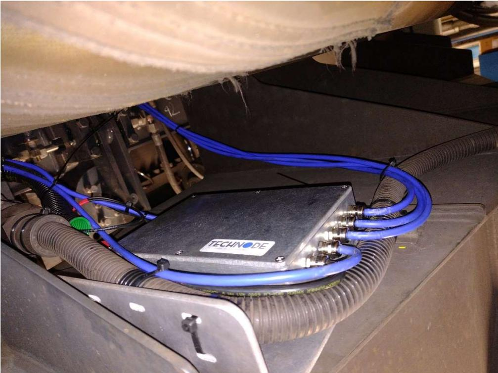
Abbildung 65: Zentralgerät railnodeG montiert am Wagenkasten unter dem Faltebalg beim Wagenübergang
