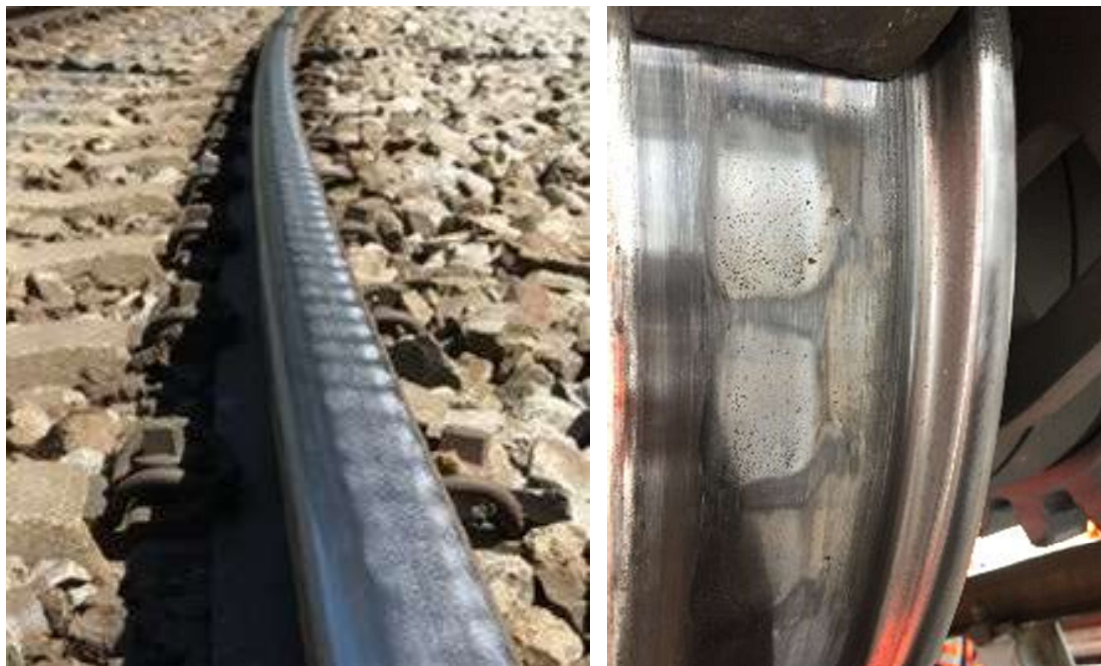
Abbildung 11: Glänzende Flecken auf der Schiene und Flecken auf dem Rad, die die Gleitbereiche der Stick-Slip-Schwingungen darstellen (Quelle: zb Zentralbahn AG).
