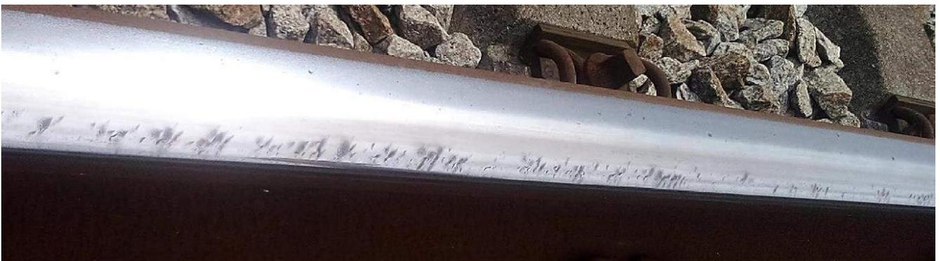
Figure 1 : Head Checks de degré 2 (2021). SNV.
