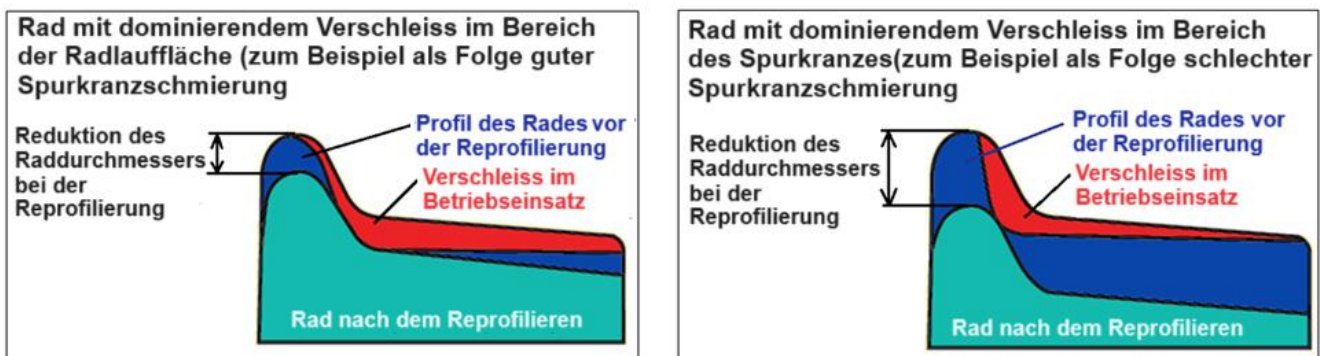
Abbildung 1: Unterschiede bei der Reprofilierung in Abhängigkeit des vorherrschenden Verschleisses an Spurkranz oder Lauffläche
