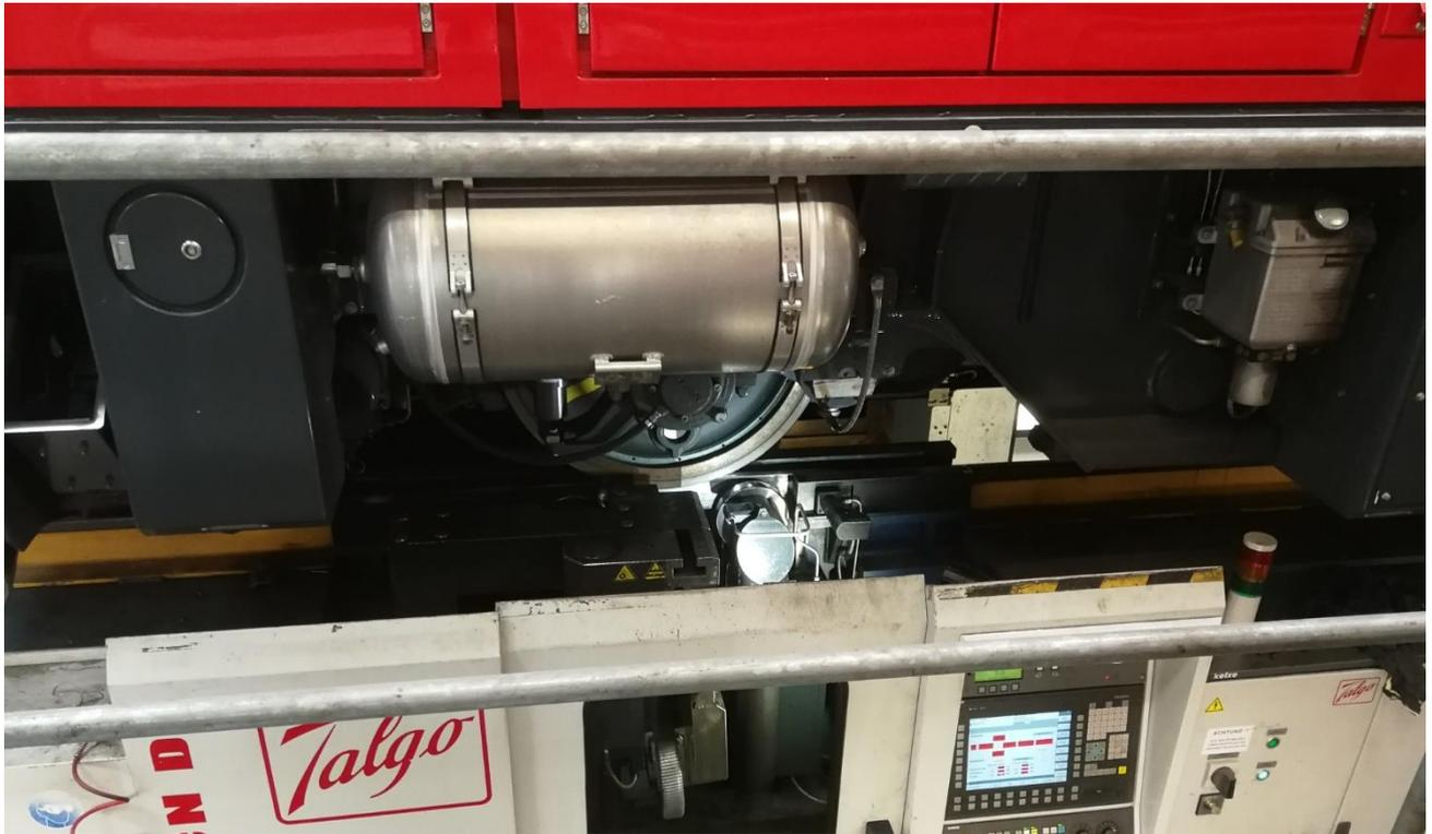
Unterflurdrehbank MGB mit Fahrzeug «Tea 2/2» (Quelle. MGBahn)
