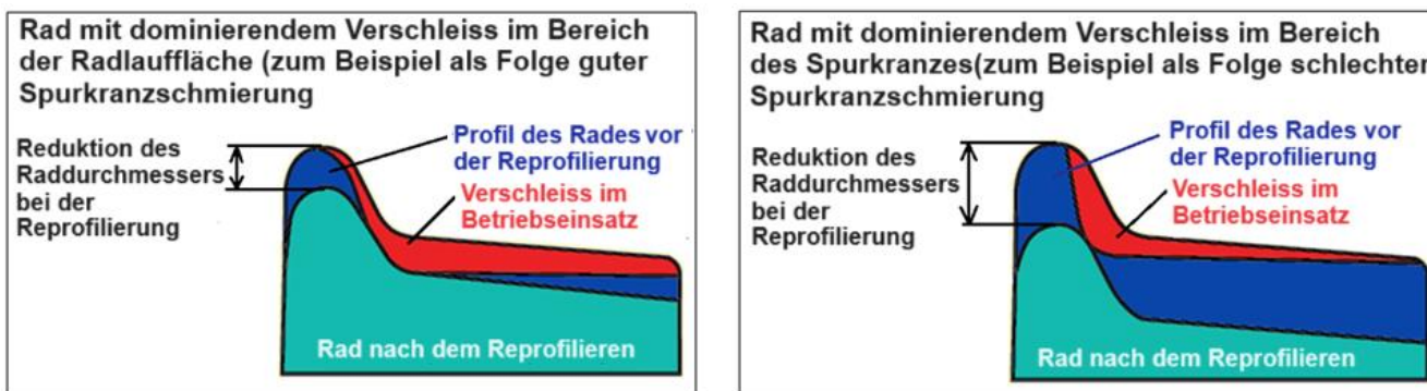
Abbildung 3: Rad vor und nach dem Reprofilieren mit geringem (links) und starkem (rechts) Spurkranzverschleiss
