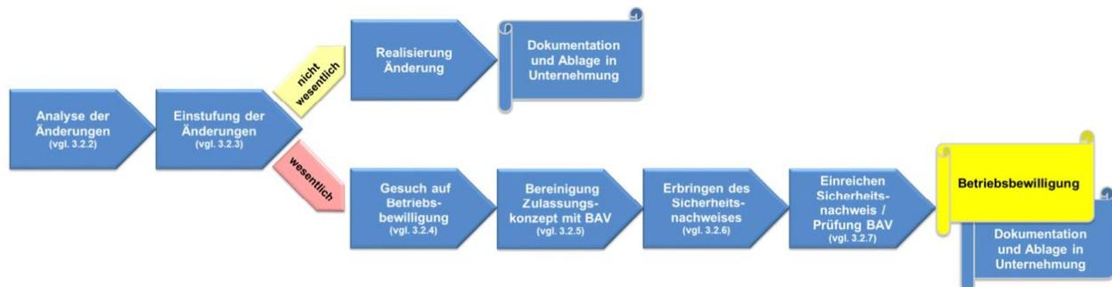
Abbildung 1: Änderungsprozess nach Richtlinie Zulassung Eisenbahnfahrzeuge [4]
